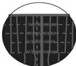
Figura 03 – Detalhe do travete aplicado sobre elástico
