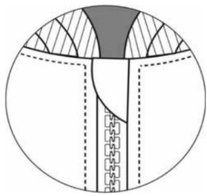
Figura 05 – Detalhe do acabamento do zíper
